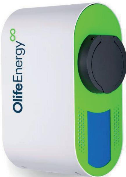
**OlifeEnergy WallBox** je odolná dobíjecí stanice pro nabíjení všech elektromobilů na trhu EU střídavým proudem (AC), výkonem až 22 kW. Určena je pro venkovní použití i instalaci do garáží, s možností montáže na zed' (wallbox) nebo na profil, kotvený do země (pole mount). WallBox může být vybaven dle přání zákazníka zásuvkou nebo kabelem (Type 2 i Type 1), případně speciálním krouceným kabelem.
