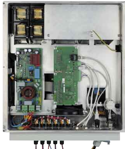
▲ Der REFUSOL 17K kommt an keinem der für die Thermografiekamera sichtbaren Bauteile in die Nähe kritischer Temperaturen, der mehrlagige Aufbau versperrt allerdings die Sicht auf den Leistungsteil
